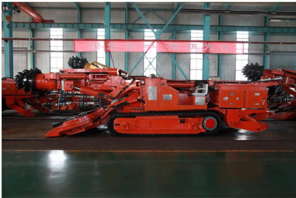
掘锚机液压系统：掘锚机液压系统包括：液压油箱、柱塞泵机组、控制系统、管路及附件。开路用于液压系统操作。液压系统采用标准液压元件设计。液压泵站由电机驱动。冷却喷淋系统：降尘，配备除尘通道和除尘风机。1. 机器配有降尘喷水系统和气体稀释系统。喷水系统：喷水系统采用特殊ITP喷嘴（降温、抑制火花）。这种喷嘴向有气体的区域供水和供气。这种辅助气流由特殊的ITP喷嘴产生。该系统由几个喷杆组成。通常，两个喷杆安装在切割滚筒的后面，两个喷杆安装在铲板上。江西液压掘锚机供应商家掘锚机的履带机构包括张紧轮、张紧链轮、驱动链轮、驱动装置和履带板。
