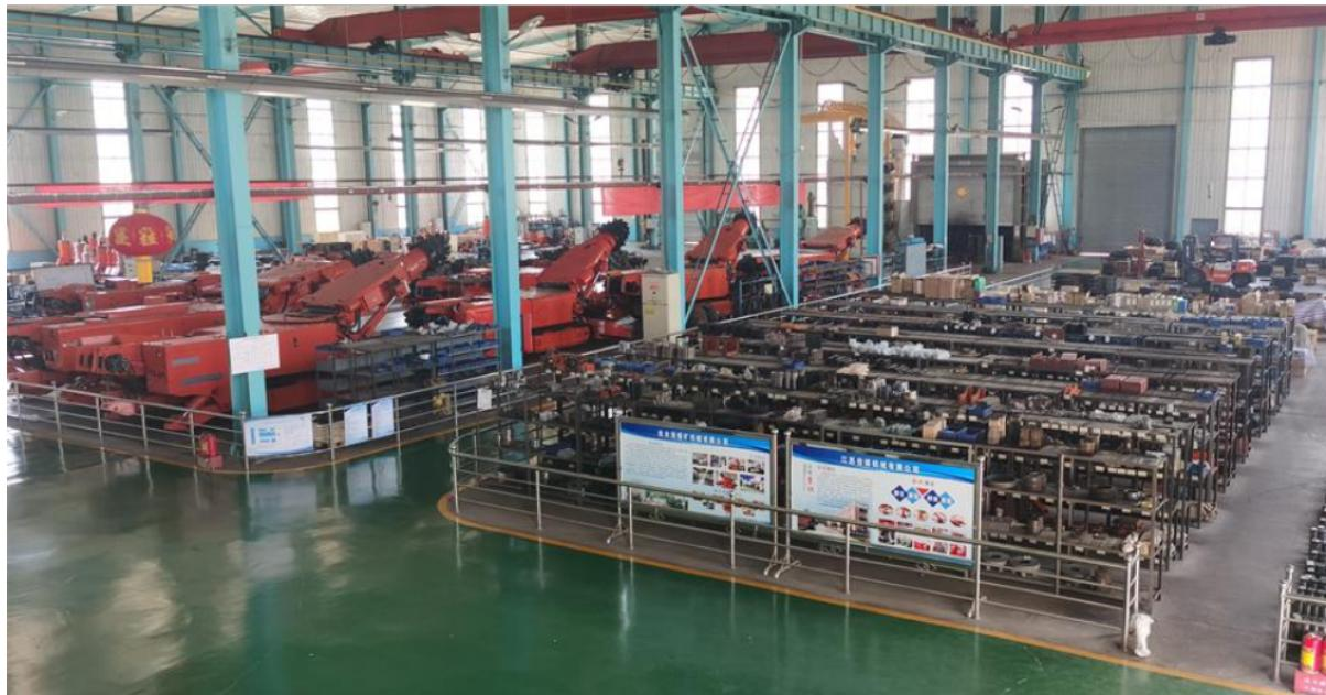
掘锚机主要由行走机构、装载转运机构、工作机构、液压系统、喷雾抑尘系统、电气系统等组成。掘锚机具有“高效、环保、安全、可靠”的特点，是适应国家煤炭行业安全、高效、智能化发展的国内外先进的掘进设备。掘锚机技术参数如下：大小全长：11.16米；总重量：约105吨；行进模式下的高度 $2.65\text{-}3.3\text{m}$ ；车身宽度：较小4.36米；切割滚筒简单边收缩尺寸：0.25米；离地间隙：0.27米；操作数据：开采宽度：5.2–6.24米；采高 $2.8\text{-}5.0\text{m}$ ；切割深度 $1.0\text{m}$ ；接地比压 $29\text{N/cm}^2$ ；四台湿式屋顶锚杆机D0200D0800两个湿侧螺栓钻；力量：总装机功率：较大546千瓦；切割电机 $1\times270\text{kW}$ ；千瓦液压驱动电机 $1\times132\text{kW}$ ；加载电机 $2\times36\text{kW}$ ；输送机电机 $2\times36\text{kW}$ 。
